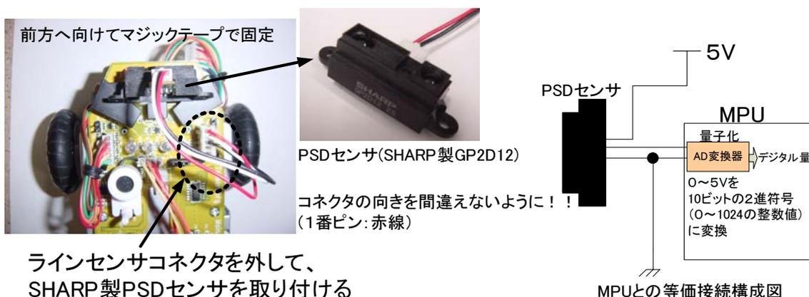
図9: PSD センサの接続と等価接続図
